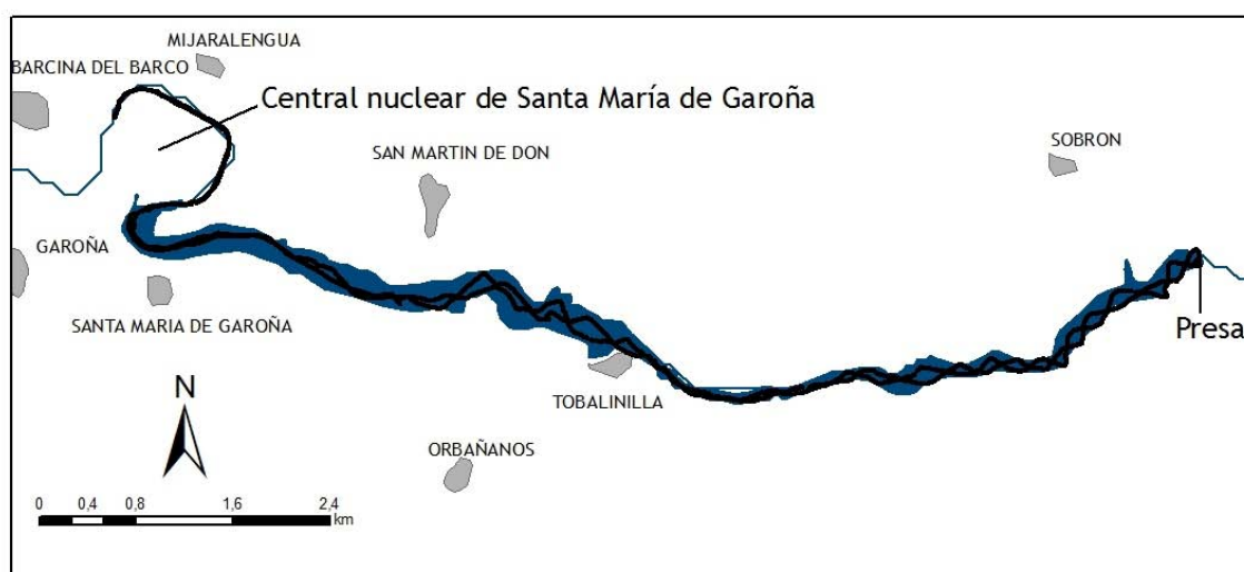
Figura 8. Recorridos de sondeo hidroacústico
