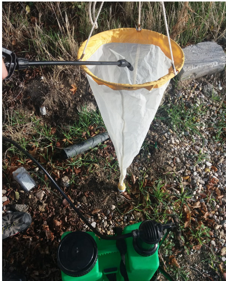
Figura 5 Desinfección del equipo de muestreo mediante atomización y solución desinfectante
