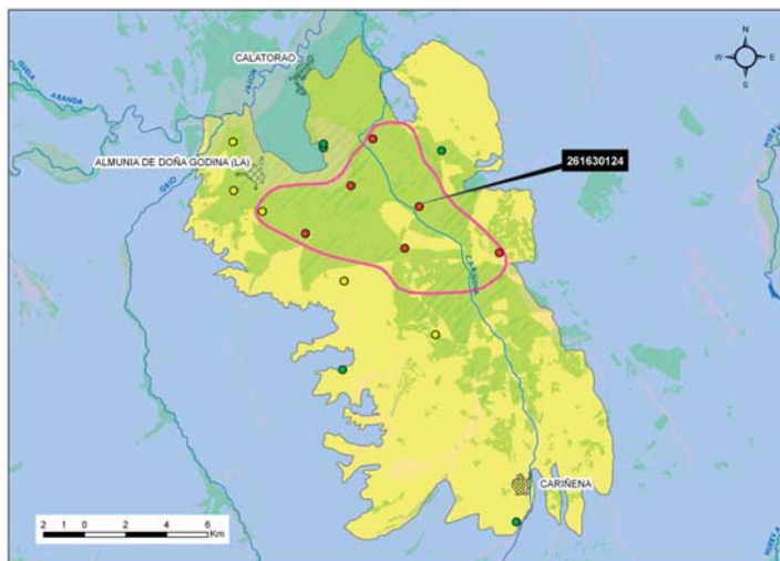
■ FIGURA 5.2.42 CONCENTRACIÓN PROMEDIO DE NO 3 - DURANTE EL AÑO 2011 EN LOS PUNTOS DE CONTROL DE LA MASA DE AGUA SUBTERRÁNEA "PLIOCUA- TERNARIO DE ALFAMÉN"
