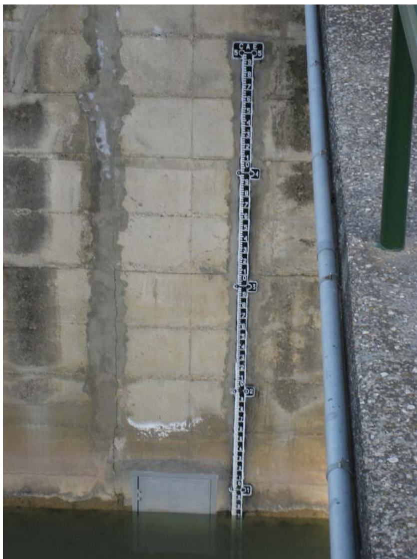
Ref. 47.- EA N°33 del río Alcanadre en Peralta de Alcofea: escala para medir el nivel.
