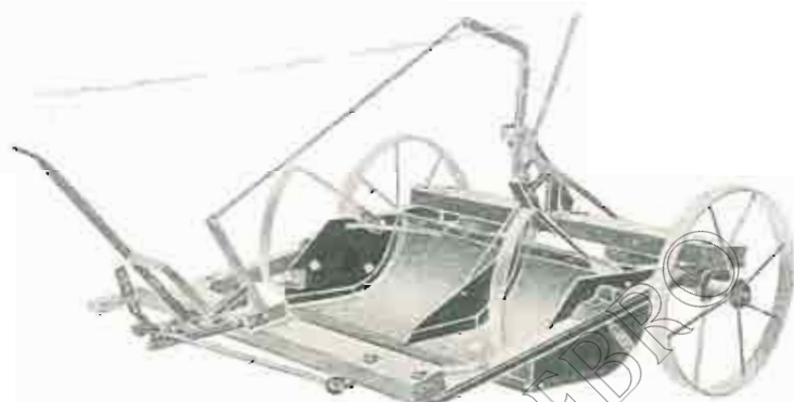
Fig. Núm. 11 b. Tralla rascador MISKIN, de descarga automática.
