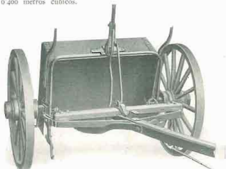
Fig. Núm. 10. Trailla o pala sobre ruedas regresando a la fosa.
