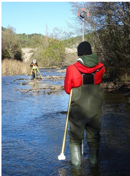
Fotografía 3. Toma de datos topográficos con estación total. Río Irati aguas abajo del embalse de Itoiz (noviembre 2023).
