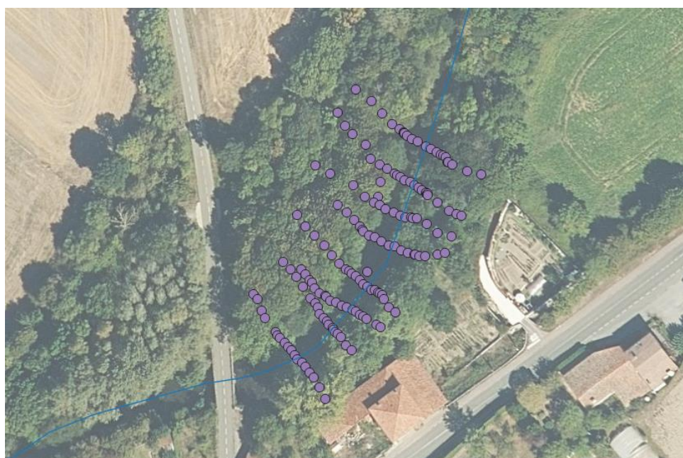
Figura 9. Perfiles realizados aguas abajo del embalse de Ullívarri
