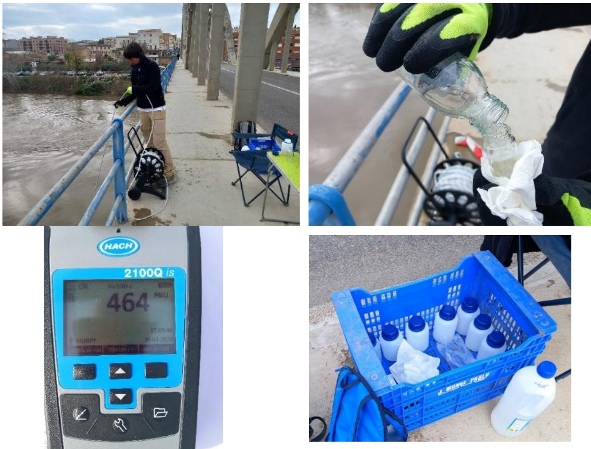
Fotografía 5. Toma de muestra y medición in-situ de la turbidez en la crecida controlado del Bajo Ebro
