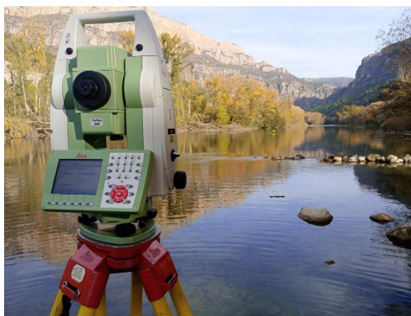
Fotografía 2. Estación Total Leika TS15 empleada en los trabajos de campo. Río Segre aguas abajo del embalse de Camarasa (noviembre 2023).
