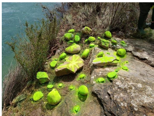
Figura 25. Comparativa de los elementos de partículas de diferentes granulometrías, antes y después de la crecida en el río Cinca (embalse de El Grado)
